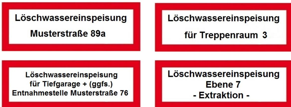
Abb. 1: Beispiele für die Kennzeichnung von Einspeisestellen
